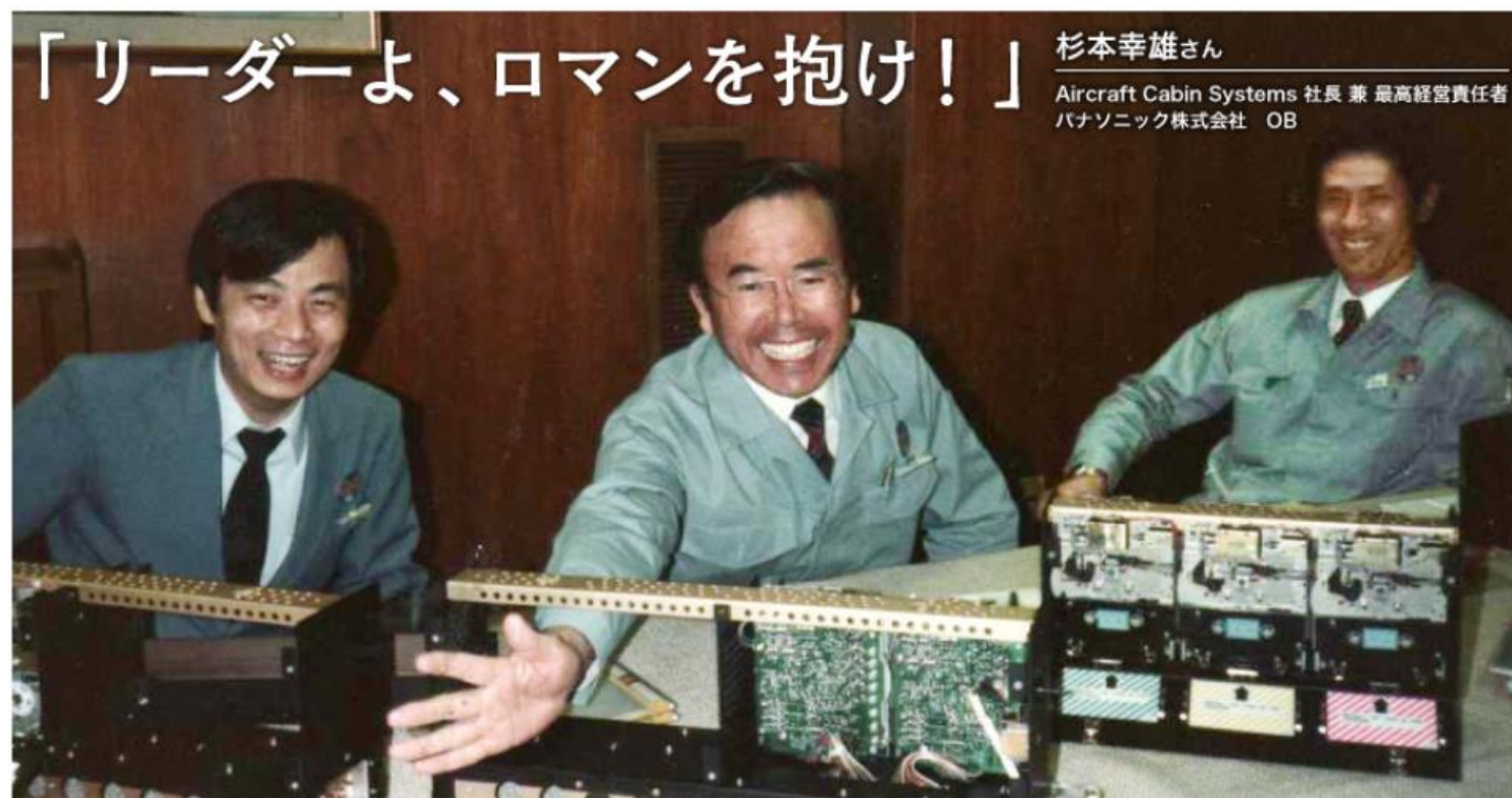
アナウンス再生装置の内部。チップ部品によって、内部が省スペースになったことを説明する杉本さん(中央)。1985年頃
